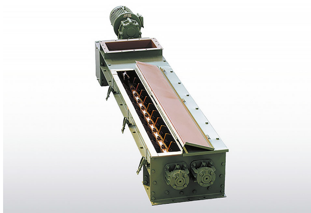
Рис. 7. Двухшнековый смеситель для смешения осадка и негашеной извести
