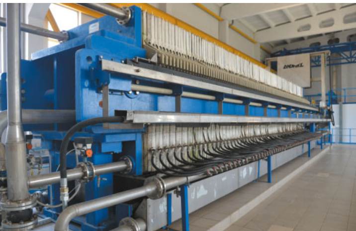
Рис. 9. Камерные мембранные фильтр-прессы
